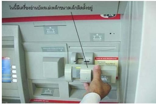
รูปที่ 11.14 ลักษณะของเครื่องอ่านข้อมูล และการติดตั้งเข้ากับเครื่องเอทีเอ็ม
