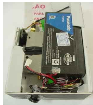
รูปที่ 11.17 ภายในของกล่องที่แอบซ่อนเพื่อดักข้อมูลของผู้ที่มากดเงินที่เครื่องเอทีเอ็ม
