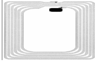
รูปที่ 4.4 รูปแสดงแท็กอาร์เอฟไอดี
